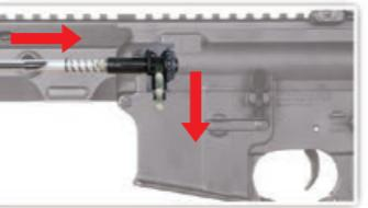
Asegúrese de introducir la varilla con la parte segmentada hacia abajo.
