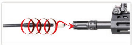
2.Inserte la varilla de limpieza dentro del cañón, girando cuando lo inserte. Repita hasta que esté limpio.
